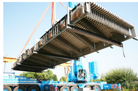
Die erste neue MSM® Schwenktraversen-Dehnfuge beim Verladen auf dem Hof bei MAURER in München.
