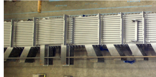
Eine der beiden 23,6 m langen Dehnfugen vom Typ Schwenktraverse DS1400 mit 14 Profilen, aufgenommen in der Fertigung in München, vor der Lieferung nach Kroatien.
