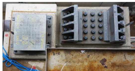
Die beiden Gegenstücke unten mit Auflagerfläche und Führungseinheit.
