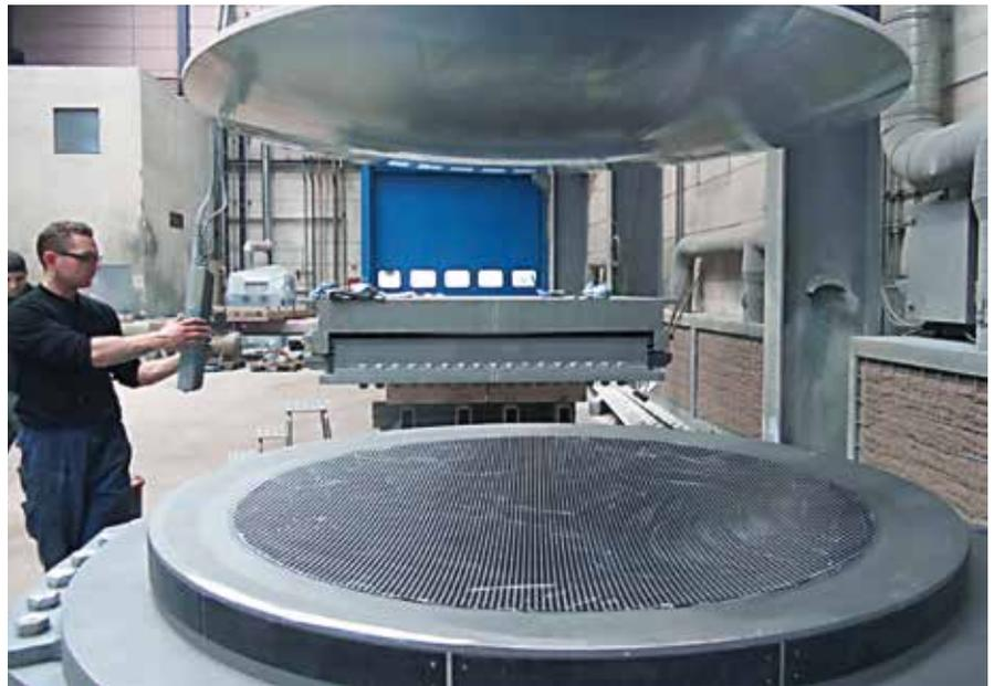
MAURER MSM® Kalottenlager für vertikale Auflasten von 220.000 kN
