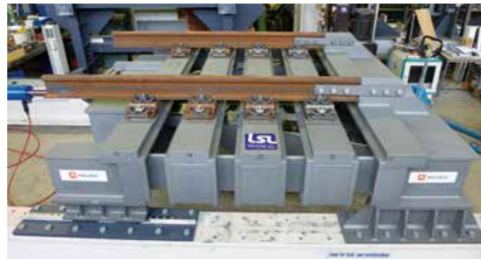
MAURER Wanderschleife für Belastungstests im Prüflabor von Prof. Bucak, Augsburg
