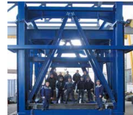
Das MAURER Werksteam veranschaulicht die Abmessungen des Stahlrahmens für die Doppelpendelmasse im SOCAR Tower in Baku / Aserbaidschan
