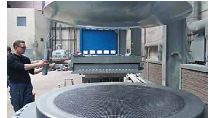
MAURER MSM® Kalottenlager für vertikale Auflasten von 220.000 kN
