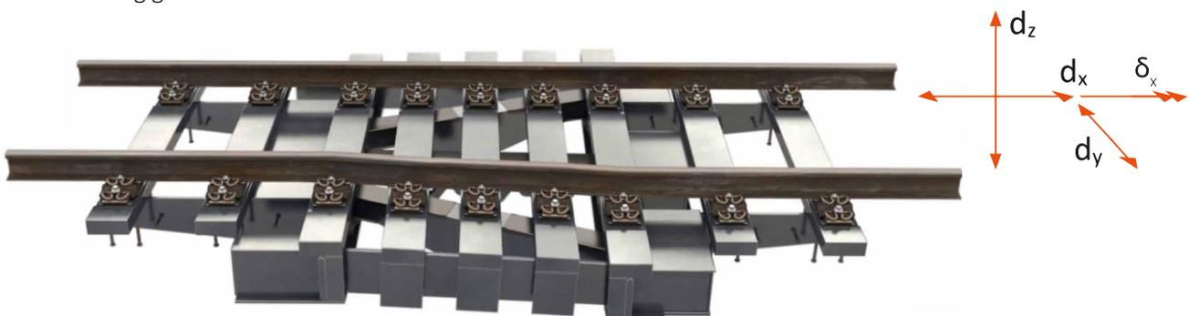
Die Wanderschwelle wurde für eine minimale Aufbauhöhe von 450 mm der Festen Fahrbahn gemäß RIL 804.5202 entworfen. Zwei Anschlussvarianten werden berücksichtigt: Die Konstruktion kann über eine Anschlussbewehrung kraftschlüssig mit dem Tragwerk gemäß der RIL verankert werden oder über eine Anschlussbewehrung an den Ausgleichsbeton der Festen Fahrbahn angeschlossen werden ohne Schutzbeton und Abdichtung zu durchbrechen.
