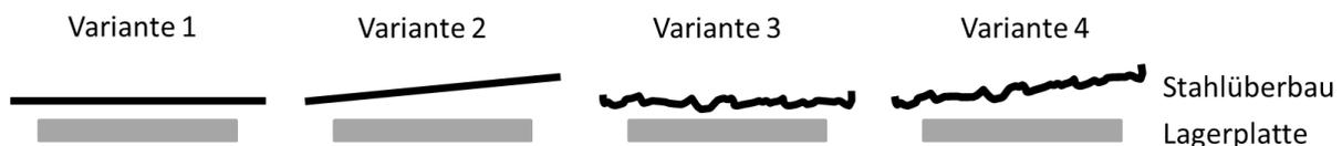
**Abbildung 12: Typische Varianten der Lagereinbausituation am Stahlüberbau**
