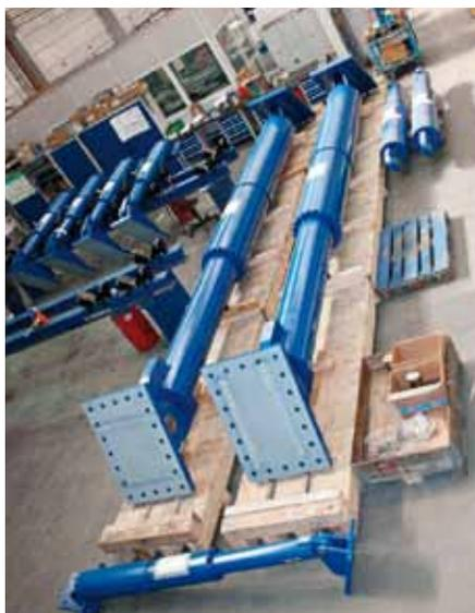
MAURER Hydraulik Dämpfer in der Münchner Fertigung
