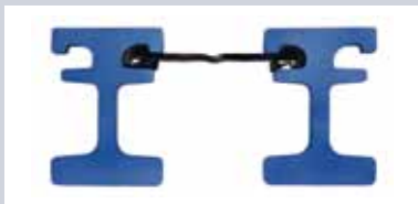
80 mm Spaltöffnung, max. Stellung
